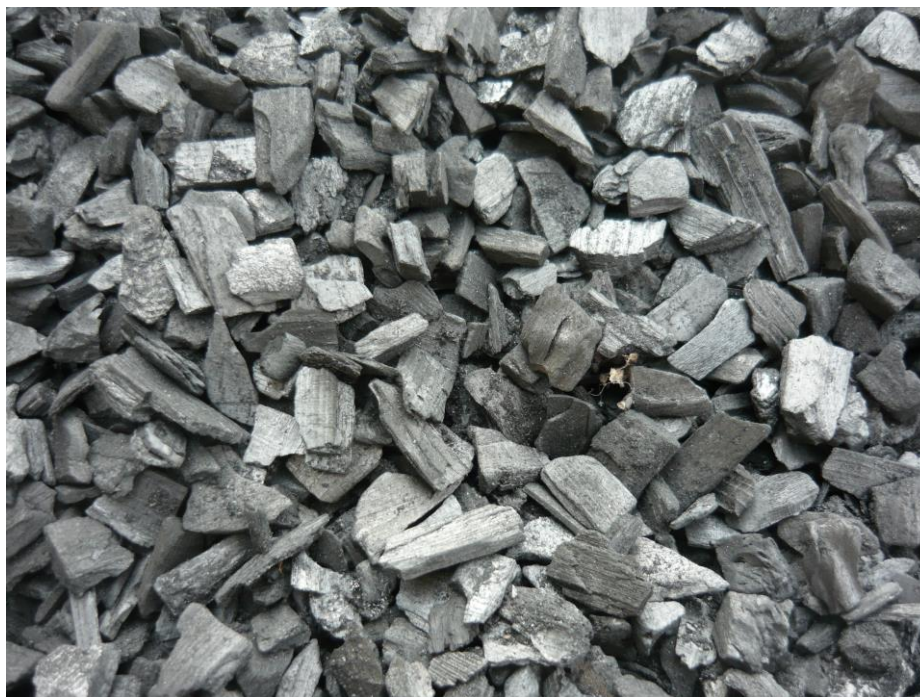
Picture 1: Biochar van houtsnippers door "Terra-Preta" met "3R" hoge temperatuur pyrolyse.
