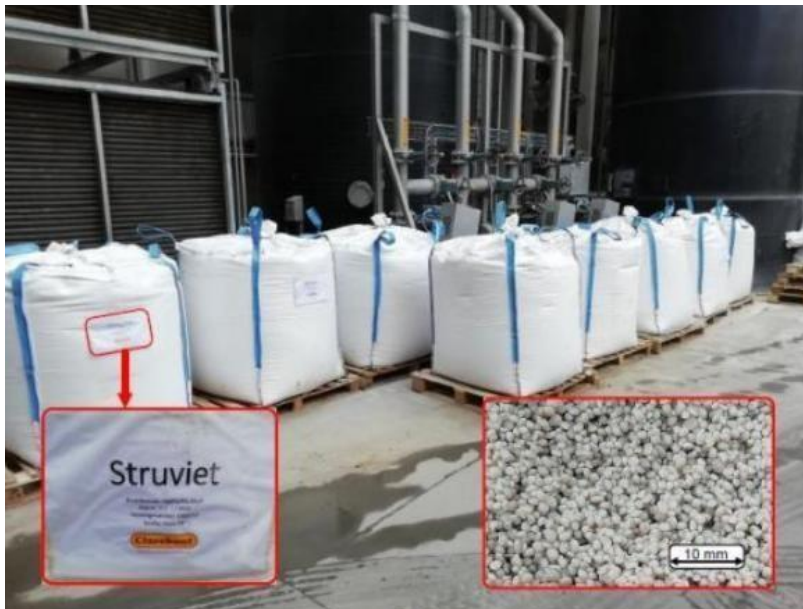
Rysunek 1. Duże opakowania struwitu od Nuresys. Po prawej widać również rozmiar mikrogranulek.
