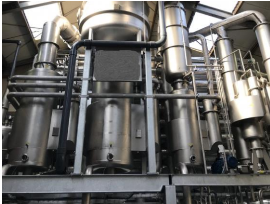
Figura 1. Sistema VP-Hobe per il recupero di NH 3 liquida (ID:1527)
