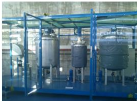
Figura 1. Impianto di digestione anaerobica a 2 fasi VALUVOIL
