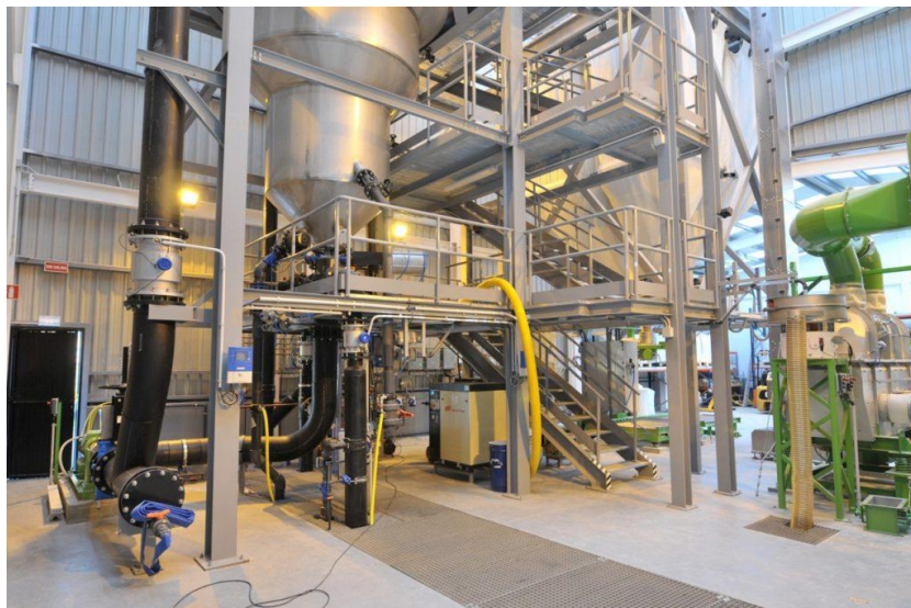
Figura 1. Tecnologia per il recupero di P come struvite mediante il processo "Canal de Isabel II S.A.".
