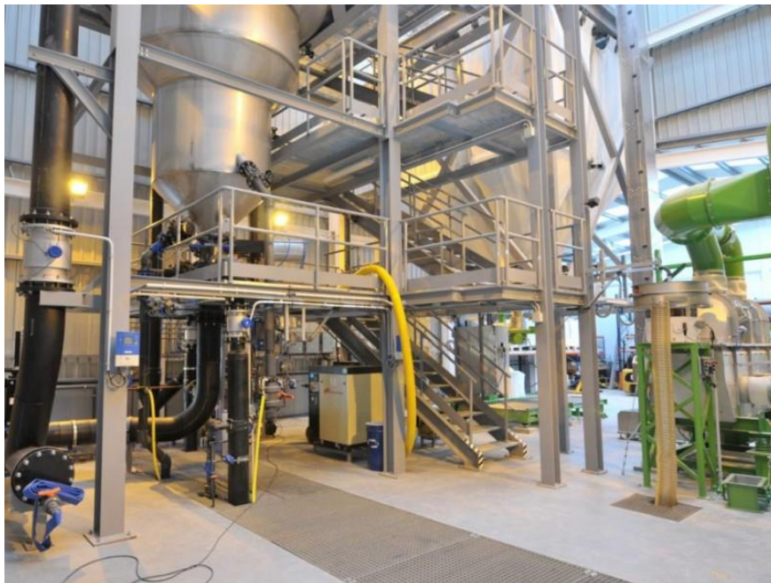
Figure 1 : Technologie pour l'extraction de P sous forme de struvite du Procédé de "Canal de Isabel II S.A."
