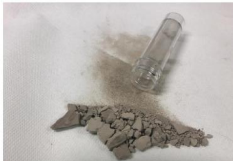
Abbildung 1.: Struvit aus dem REVAWASTE Prozess
