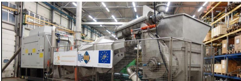
1. ábra Mobil hígtrágya-kavitátor kísérleti üzem.
