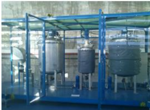
1. ábra VALUVOIL 2 fázisú anaerob fermentáló üzem
