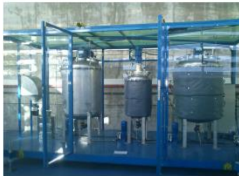
Figuur 1. VALUVOIL tweefasig anaerobe vergistingsinstallatie
