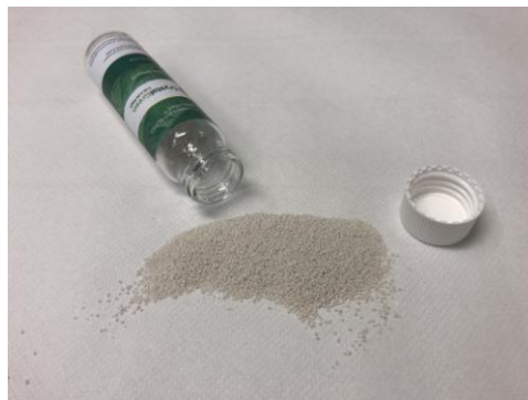
1 ábra: Szennyvízből "Canal de Isabel II S.A." eljárással előállított struvite
