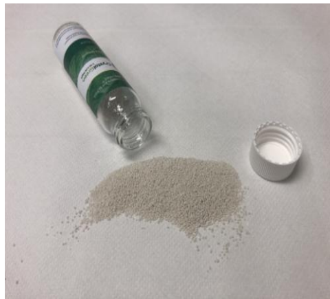
Figure 1. Estruvita procedente de aguas residuales mediante el proceso del "Canal de Isabel II S.A."
