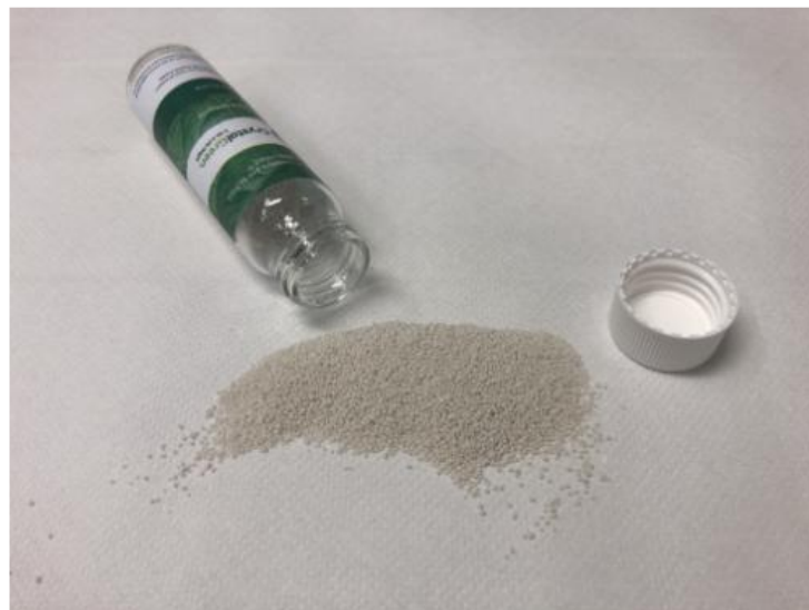
Rys. 1. Struwit pozyskany ze ścieków wodnych przez "Canal de Isabel II S.A."
