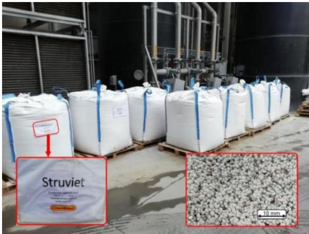
Figuur 1. Grote zakken met Nuresys 'struviet. Rechts zie je ook een voorbeeld van de grootte van de microgranules.
